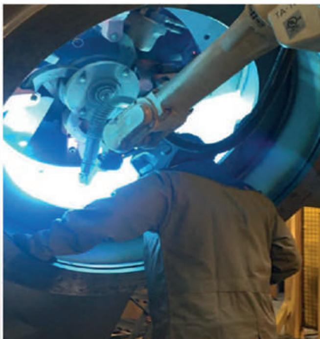
que colocamos a tocha para realizar a soldagem. O ângulo de ataque pode mudar conforme o processo ou a necessidade de maior ou menor penetração de solda.
