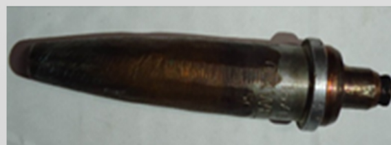
Figura 03 - Bico de corte desbastado indevidamente
