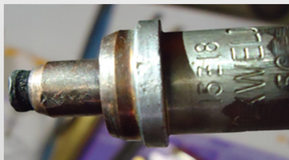
Figura 02 – Sede danificada do bico de corte.
